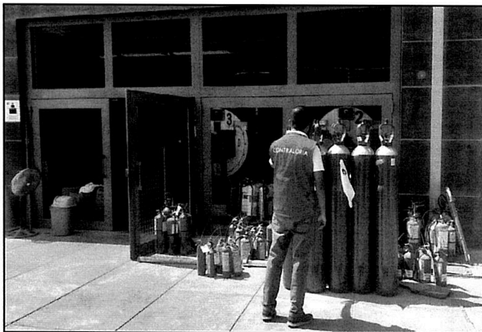
Figuras n.ºs 6 y 7: Inadecuado almacenamiento de balones de oxígeno.
