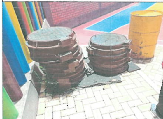
Fotografía n.º 43: se ve en la imagen tapa de buzones oxidados por estar expuesto a la lluvia y otros factores climáticos.
