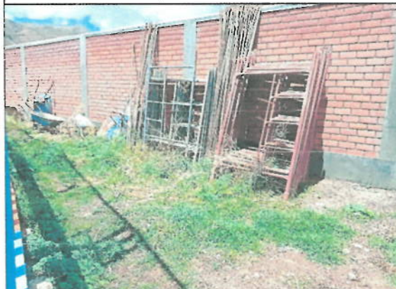
Fotografía n.º 47: Se observa en la imagen andamios y carretillas con signos de oxidación por factores climáticos.
