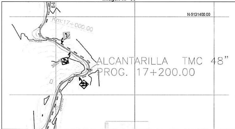
Esta imagen, que es parte del plano clave km 0+000 a km 21+771.25, no contempla una estructura en reemplazo del pase rústico de agua (Imágenes n.<sup>o</sup>s 31 y 32)
