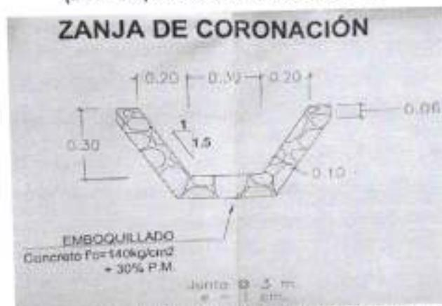
Plano DCU - 02 de detalle de cunetas de banquetas o coronación (concreto  $f_c=140 \text{ kg/cm}^2 + 30\% \text{ P.M.}$ )
