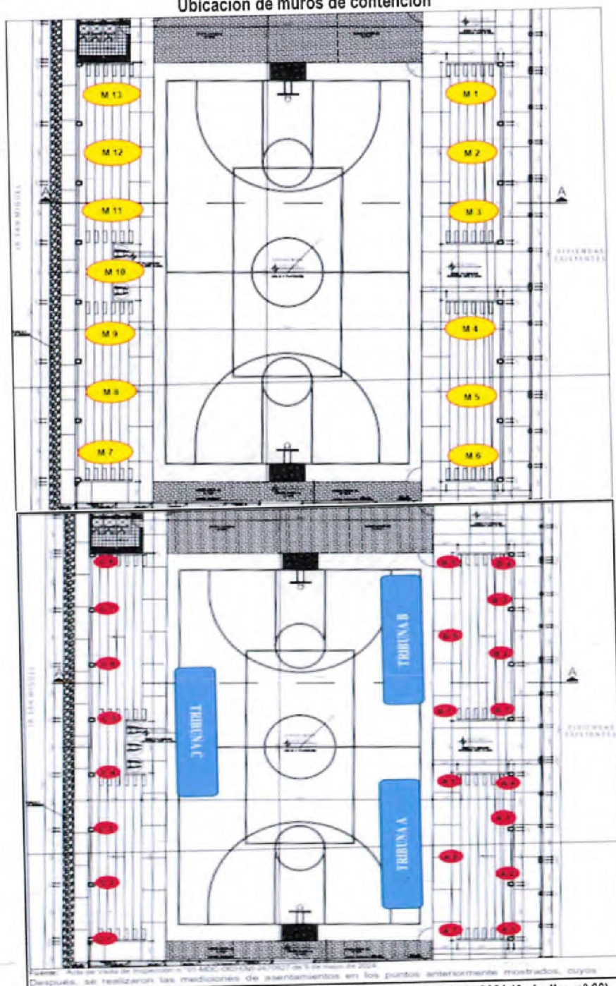
Imágenes n.º 14 y 15 Ubicación de muros de contención
