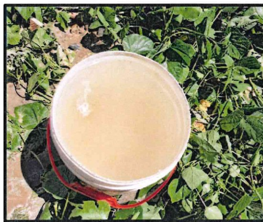
Imagen n.º 7 Muestra de agua turbia y partículas de arena extraída del pozo
