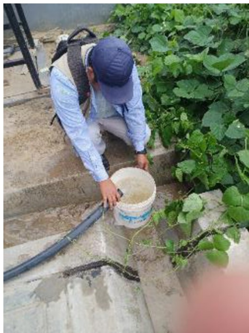
Fotografía N°03: Medición de caudal bombeo Q=0.82 lit/seg.
