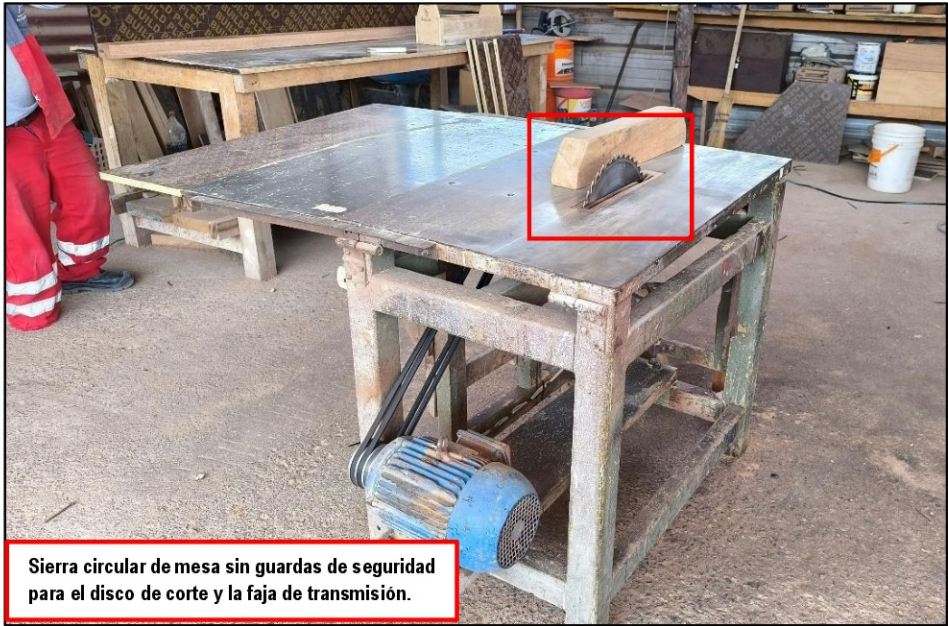
Imagen n.º 67 Falta de guardas de seguridad en la sierra circular de mesa.
