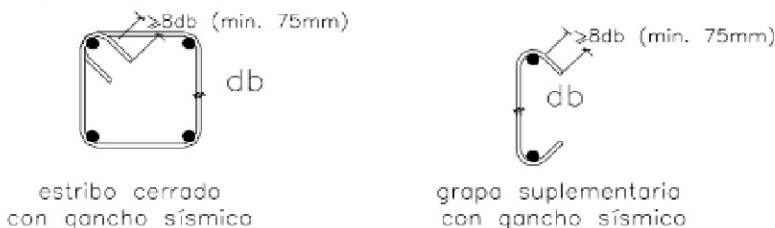
Fig. 21.1d Ganchos sísmicos en estribos y grapas suplementarias
