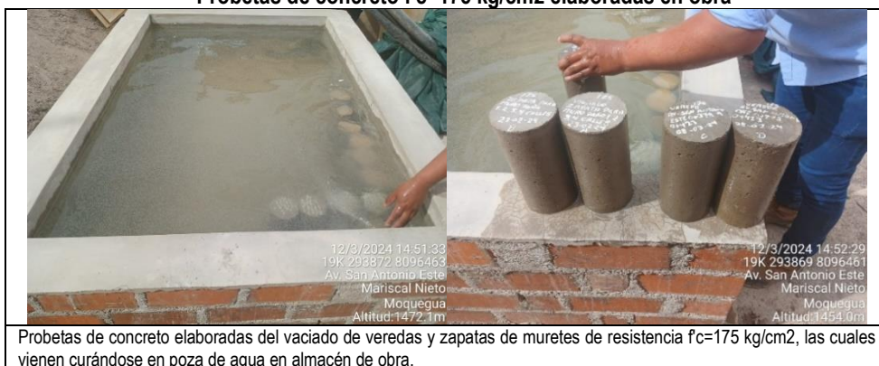
Imagen n.º 3 Probetas de concreto f'c=175 kg/cm 2 elaboradas en obra
