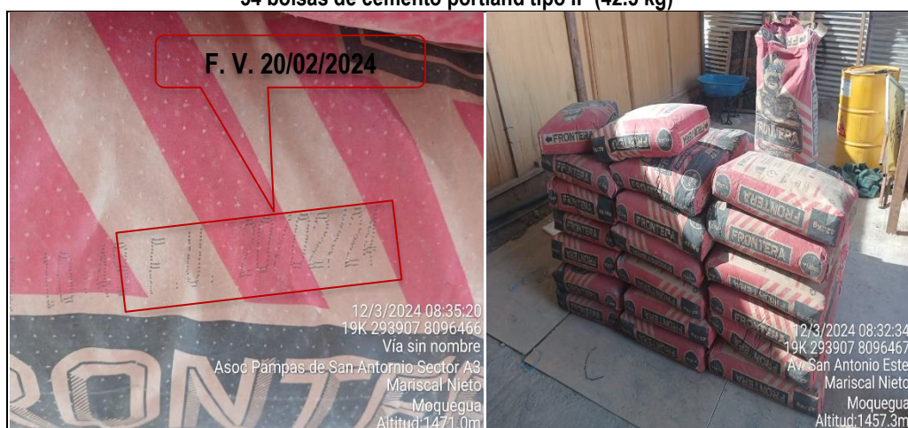
Imagen n.º 9 54 bolsas de cemento portland tipo IP (42.5 kg)
