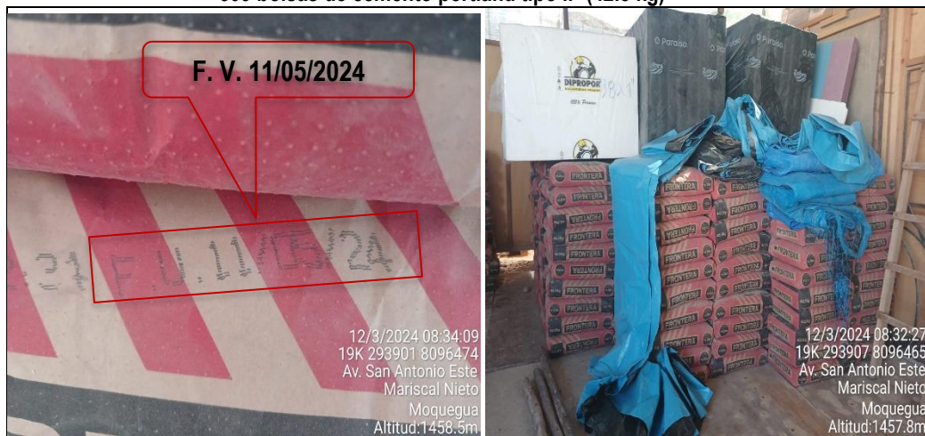
Imagen n.º 8 509 bolsas de cemento portland tipo IP (42.5 kg)
