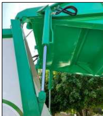
Imagen n.º 7 Cilindro hidráulico utilizado para el levantamiento del tailgate
