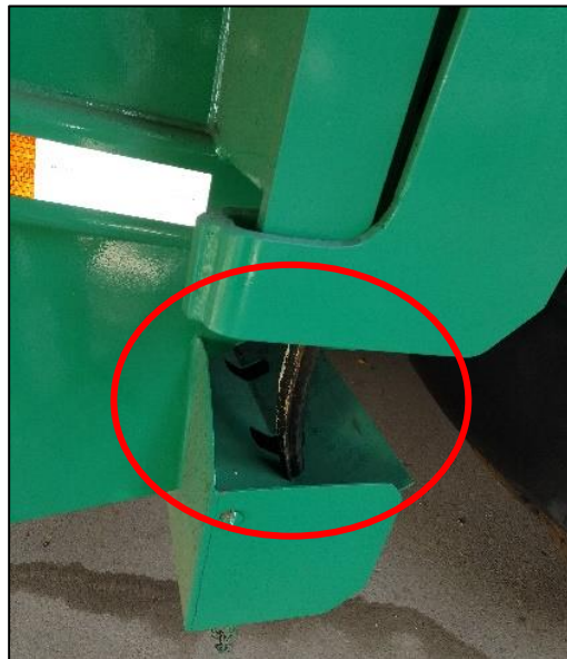
Imagen n.º 4 Burlete de caucho desprendido en compactadora con chasis n.º 9BM958156PB282954
