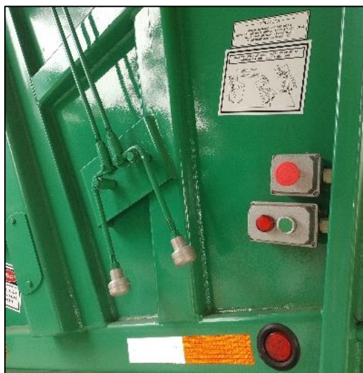
Imagen n.º 2 Palancas de accionamiento del sistema de compactación
