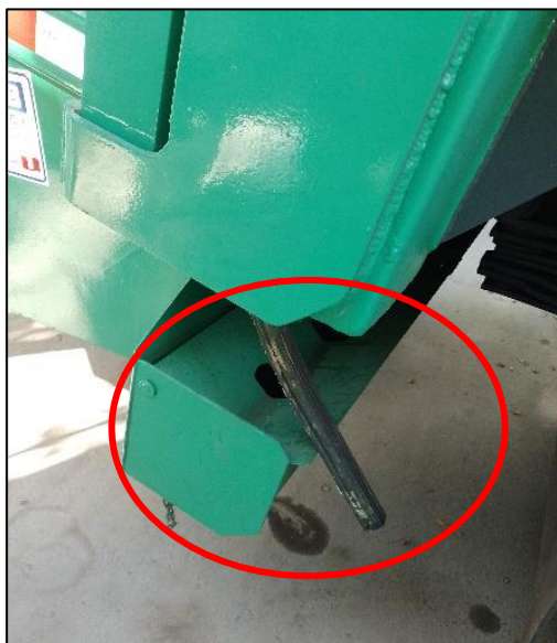
Imagen n.º 5 Burlete de caucho desprendido en compactadora con chasis n.º 9BM958156PB283075
