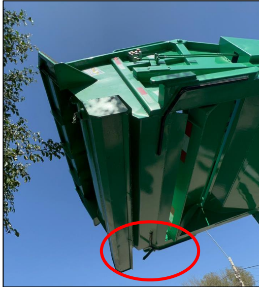
Imagen n.º 3 Burlete de caucho desprendido en compactadora con chasis n.º 9BM958156PB291110
