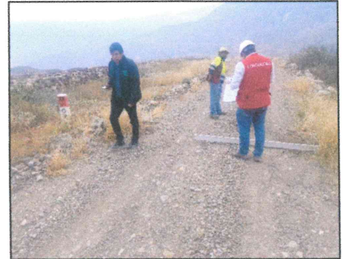
FOTOGRAFÍA N° 10 MEDICIÓN DE PARTÍCULAS DE AFIRMADO (KILOMETROS 9+000)
