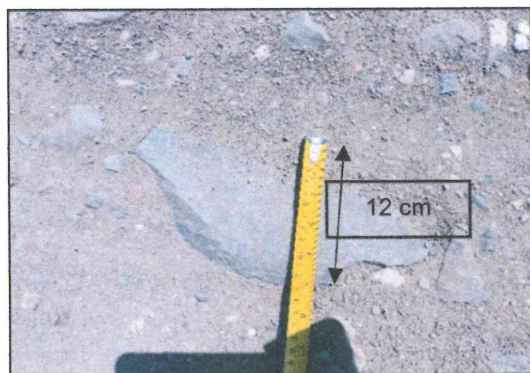
FOTOGRAFÍA N° 3 MEDICIÓN DE PARTÍCULAS DE AFIRMADO (KILOMETROS 6+000 - 7+00)
