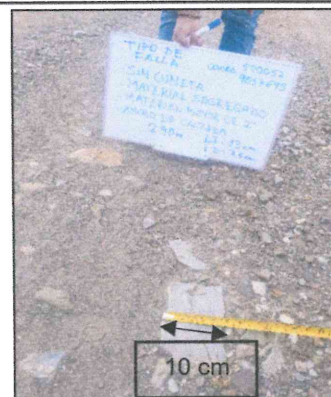
FOTOGRAFÍA N° 4 MEDICIÓN DE PARTÍCULAS DE AFIRMADO (KILOMETROS 8+000 - 9+000)
